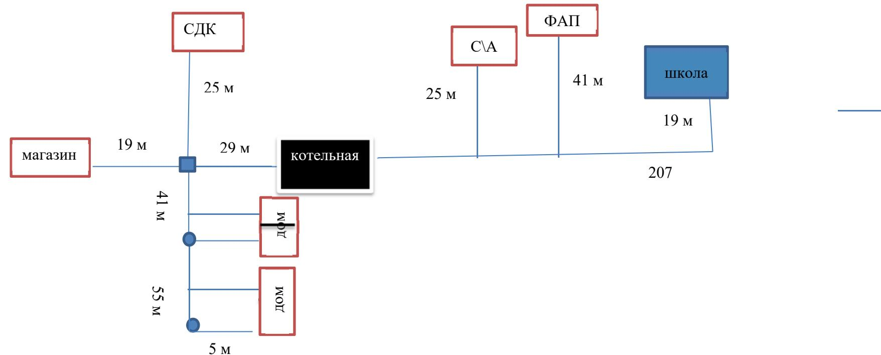
Рисунок 1.3.2.1 – Схема теплоснабжения Филиала МБОУ Ирбейская СОШ №1 – Мельничная ООШ
